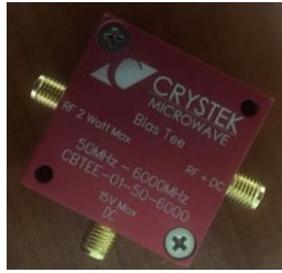
Şekil 6. HPND-4028 PIN diyotu aktif etmek için kullanılan Bias tee ve eşdeğer devre modeli.
