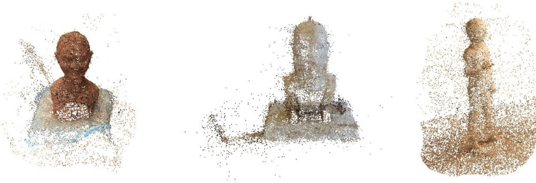
Şekil 5. Ön dengeleme sonrasında oluşan seyrek nokta bulutu (Sol: Objekt 1 – Orta: Objekt 2 – Sağ: Objekt 3)
