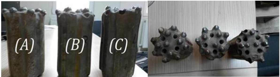
Şekil3.Çalışma kapsamında kullanılan delici uçların delgi işlemleri sonrası durumu (A):A tipi(Buton), (B) : B tipi (Yarı Balistik), (C) : A tipi (Yarı Balistik)
