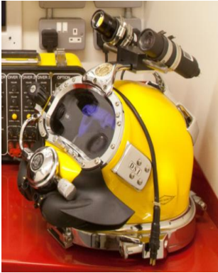
Şekil 1, 2. Sanayi dalışlarında kullanılan sert başlık ve kamera aparatları ( https://www.smp-ltd.com/ ) ( https://www.dalishshop.com/ ).
