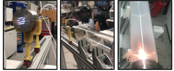
Şekil 1. Sentezlerde kullanılan ASP reaktörünün genel görünümü (Tozun toplandığı bölgenin raporlanması için sunulmuştur).
