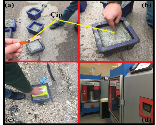
Şekil 14. Betonda RIFID uygulaması (a- betonun kalıplara doldurulması, b- çipin beton içerisine gömülmesi, c- el terminali ile çipin okutulması, d- çipli betonun test edilmesi) (Zekiylıdırım, 2023)
