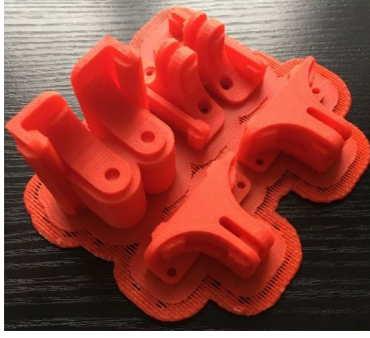
Şekil 20. Farklı doğrultularda basımı yapılmış bağlantı parçasına ait baskılar (Mieloszyk vd., 2019).
