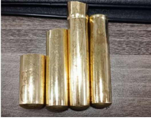
Şekil 18. 670°C Sıcaklıkta 1 Saat Tavlanan CuZn30 Kovan Yüksük Derin Çekme İşlemi
