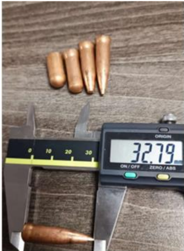
Şekil 11. 650°C CuZn10 Mermi Yüksük Numunesi Derin Çekme Sonrası Boy Uzaması
