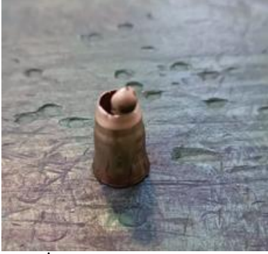
Şekil 6. Isıl İşlemsiz CuZn10 Mermi Yüksük Numunesinin Derin Çekme Operasyonundaki Durumu
