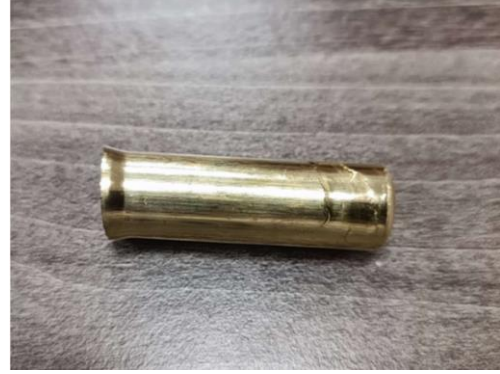
Şekil 16. 400°C Sıcaklıkta 1 Saat Tavlanan CuZn30 Kovan Yüksük Derin Çekme İşlemi
