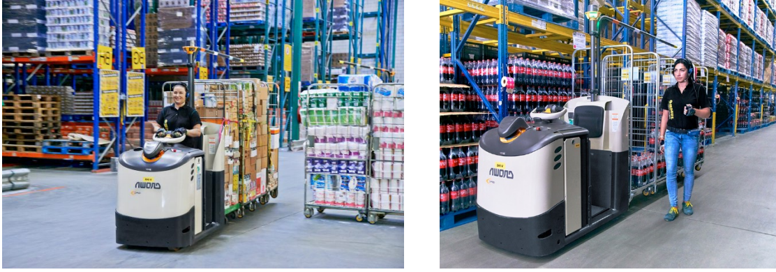
Şekil 2. Kolaboratif Sipariş Toplama sisteminde a) sürüş ve b) yürüyüş durumları (Crown Equipment Corporation, 2013)
