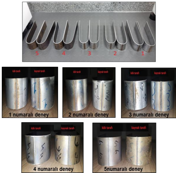
Şekil 10. Eğme testi sonrası numuneler (Samples after bending test)
