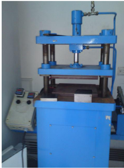
Figure 6. Hot Press Device (Sıcak Pres Cihazı)
