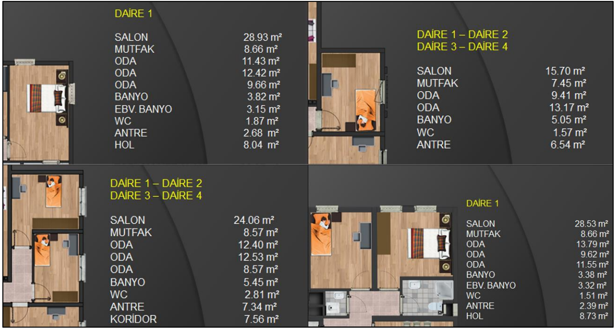
Şekil 2. TOKİ A, B1, C1, D Tipi Kat Planları [17] (TOKİ A, B1, C1, D Type Floor Plans)
