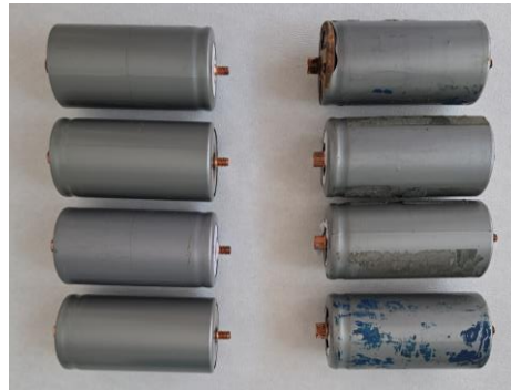
Şekil 6. Atık LFP Batarya (Yazarlar Tarafından Temin Edilmiştir) (Spent LFP Battery (Provided by the Authors))
