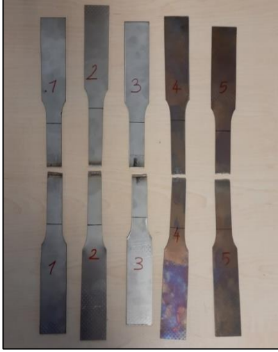
Şekil 9. Çekme testi sonrası numuneler (Samples after tensile test)
