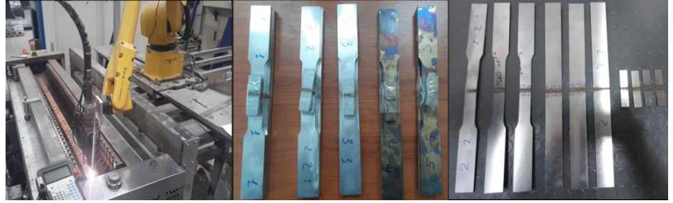
Şekil A: Lazer kaynağı ile birleştirilmiş numuneler / Figure A: Samples assembled by laser welding
