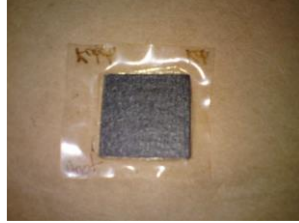
Figure 5. Membrane Electrode Assembly (Membran Elektrot Düzeneği)
