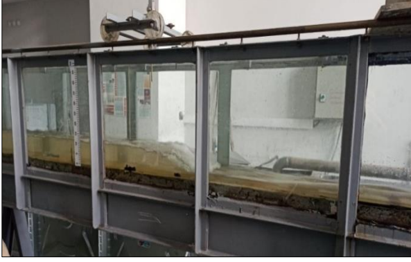
Şekil 8. Laboratuvar ortamında gözlenen tipik bir hidrolik sıçrama olayı.
