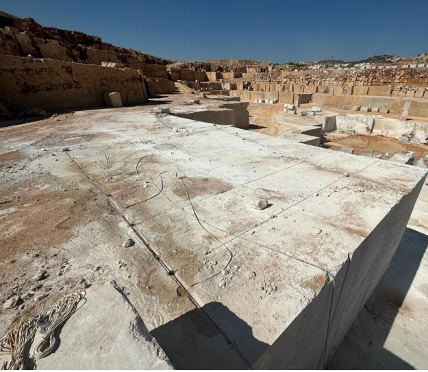
Şekil 8. Kesimler sonrası yıkıma hazır tepelemelerin üstten görünüşü
