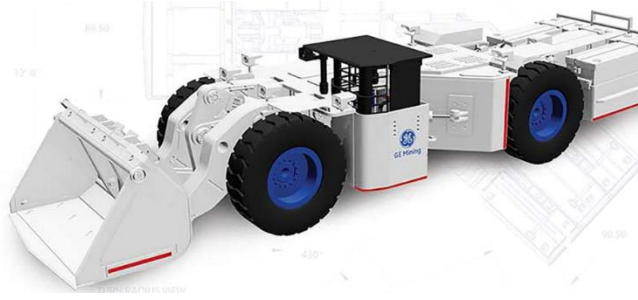
Şekil 1. LHD yükleme-taşıma-boşaltma iş makinesi (Nieto vd., 2020) (LHD loading-hauling-dumping machine)
