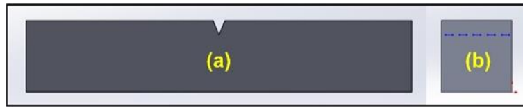
Şekil 2. Çentik darbe (Charpy) testi numunelerinin katı modeli (a) Ön görünüş (b) Yan görünüş
