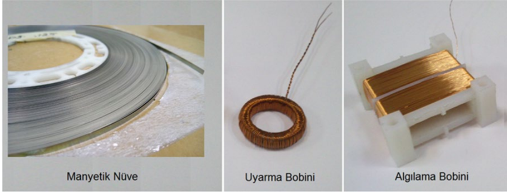
Şekil 1. Fluxgate sensörü oluşturan temel bileşenler.
