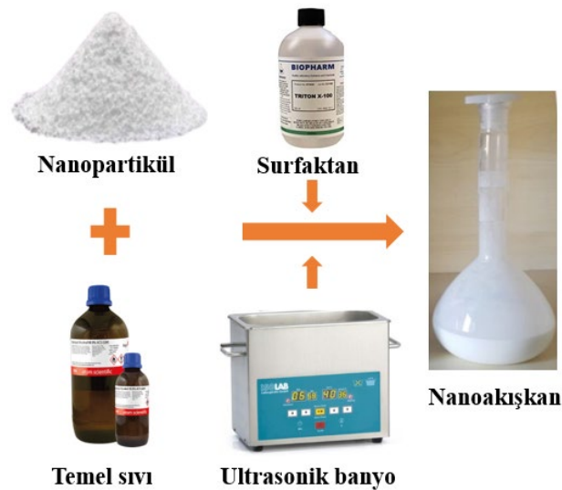
Şekil 1. Nanoakışkan hazırlanması grafik gösterimi.
