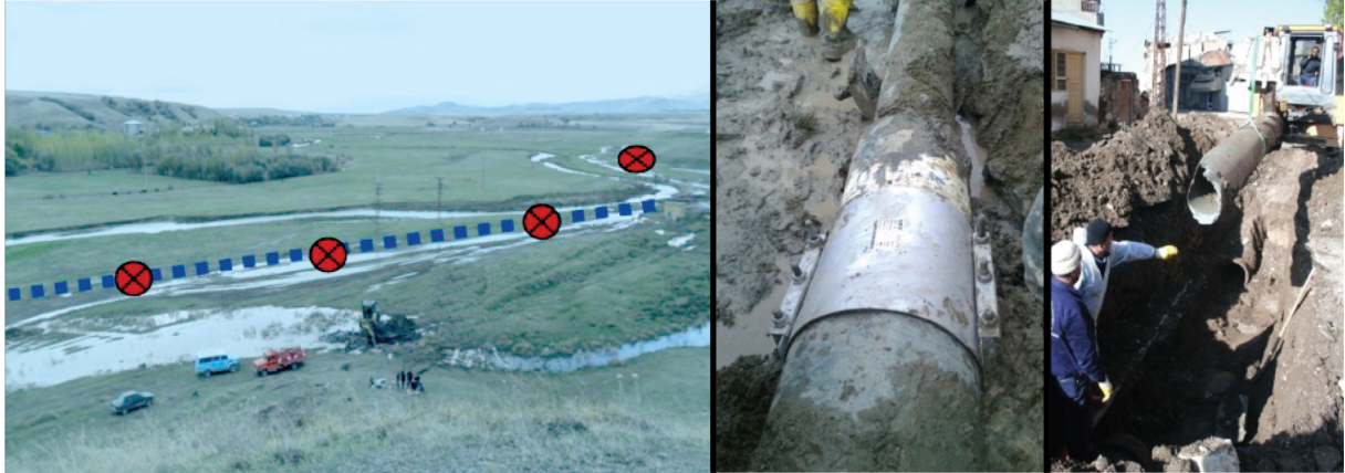
Şekil 4. 2011 Van depremlerinde gözlenen yer altı su ve atık su borularındaki hasarlar (Uçkan, 2013, Uçkan ve ark., 2016).
