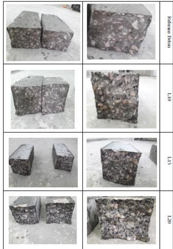
Şekil 13. Prizma numunelerinin darbe deneyi sonucu kırılma tipleri
