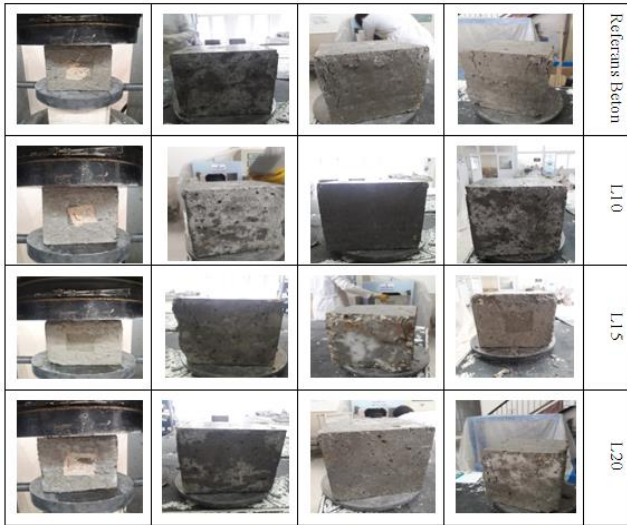
Şekil 11. Küp numunelerin basınç deneyi sonrası kırılma tipleri
