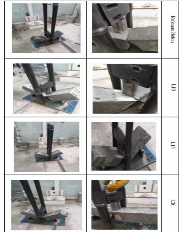
Şekil 12. Prizma seri numunelerin darbe deneyi Figure 12. Impact test of prism series samples
