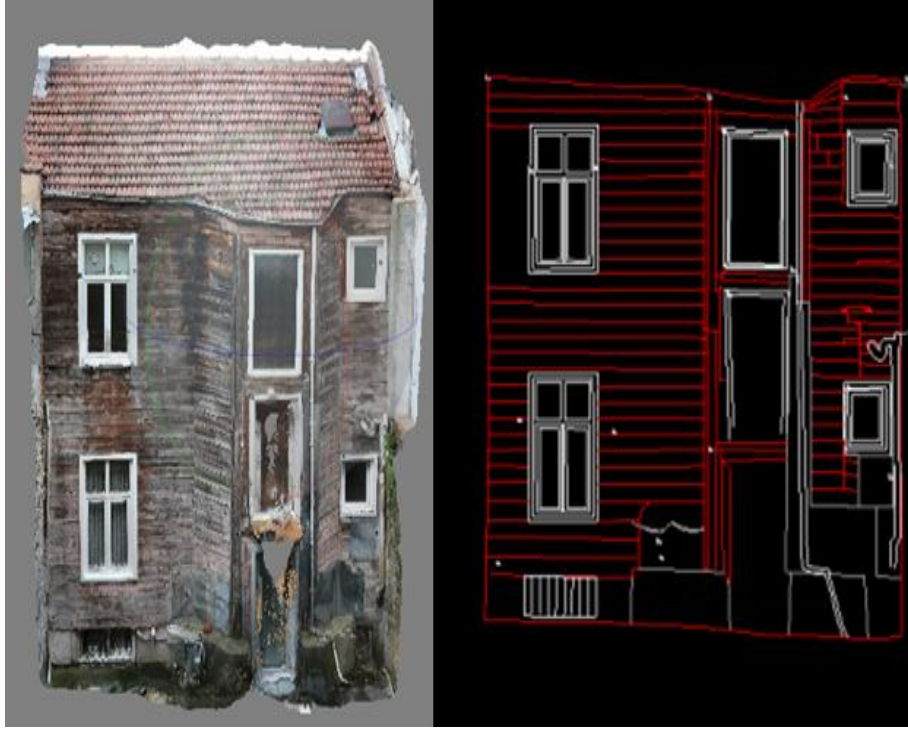
Şekil 10. Arka cephe rölövesi
