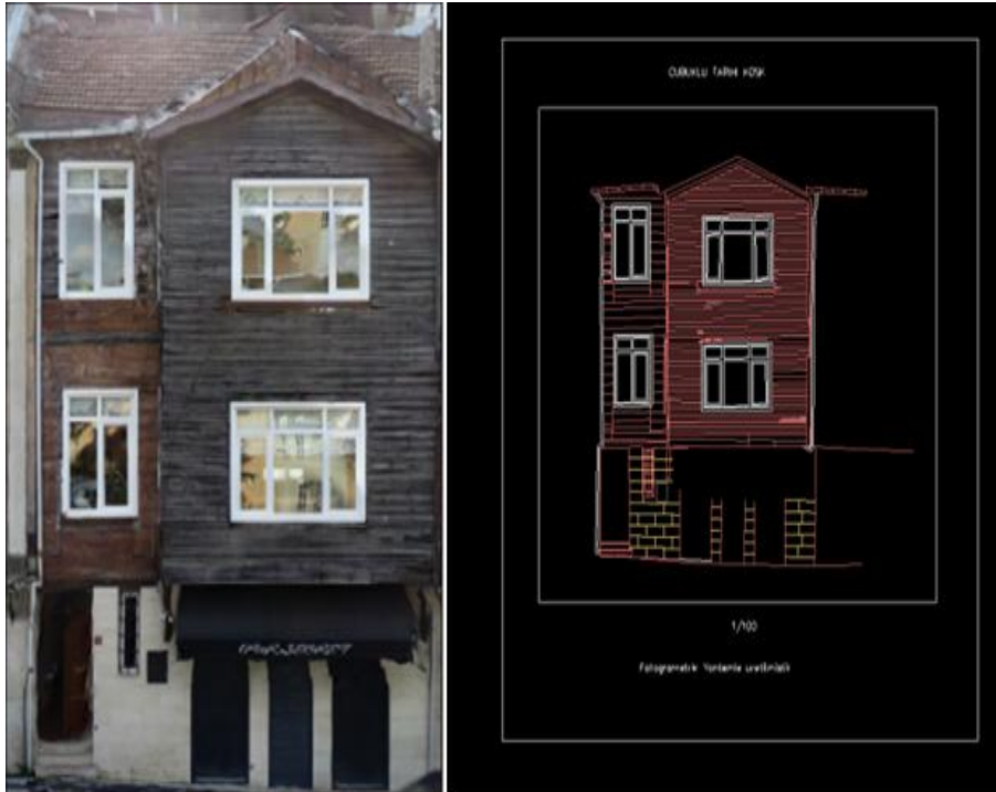
Şekil 9. Ön cephe rölövesi
