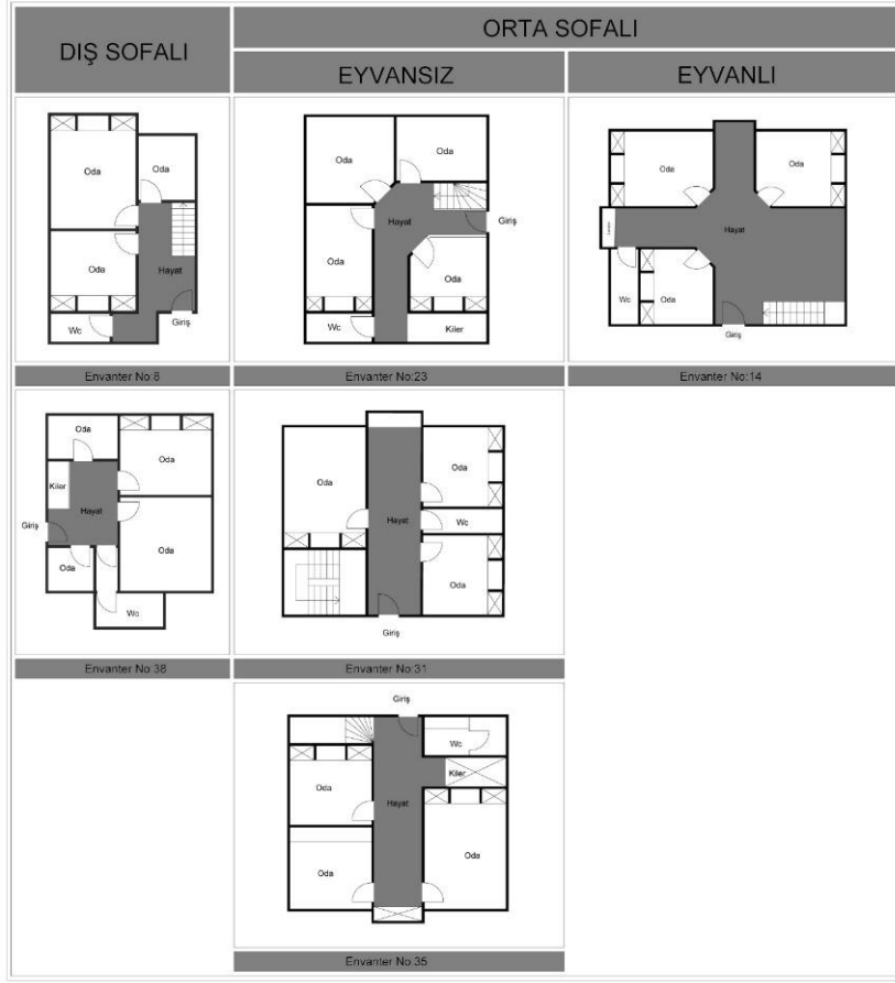
Şekil 12. İç Mekânına Girilebilen Kırsal Evlerin Plan Tipolojisi
