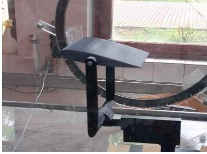
Şekil 3: Test bölümünde kuvvet ölçüm cihazına bağlı olan 3d yöntemi ile baskısı alınan NACA0015 kanat profili.
