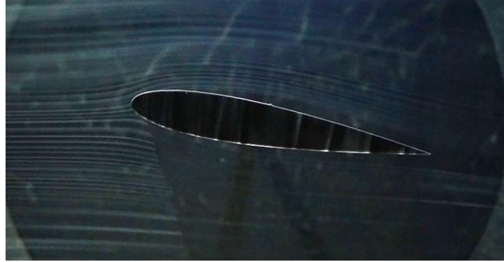
Şekil 8: Akış görüntüleme deneyleri 9 derece.
