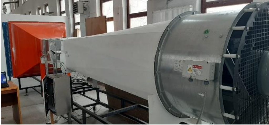
Şekil 2: Sesaltı rüzgâr tüneli.
