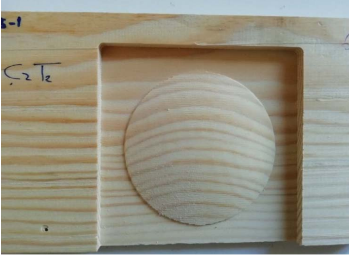
Şekil 2. Rölyef olarak işlenmiş bir test örneđi.
