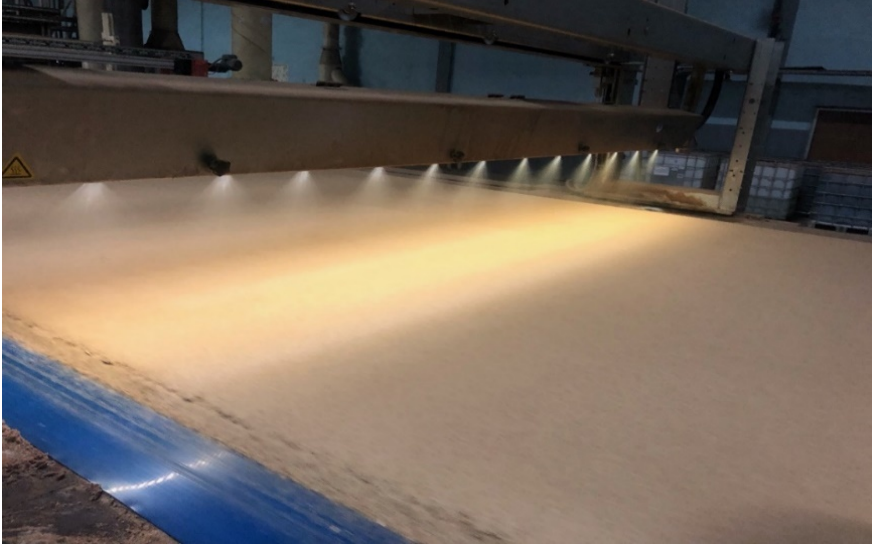
Şekil 2. Levha taslağı üzerine KAK püskürtme işlemi.
