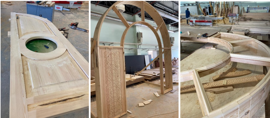
Şekil 13. Kemerli kapı kanatlarının konstrüksiyonu.
