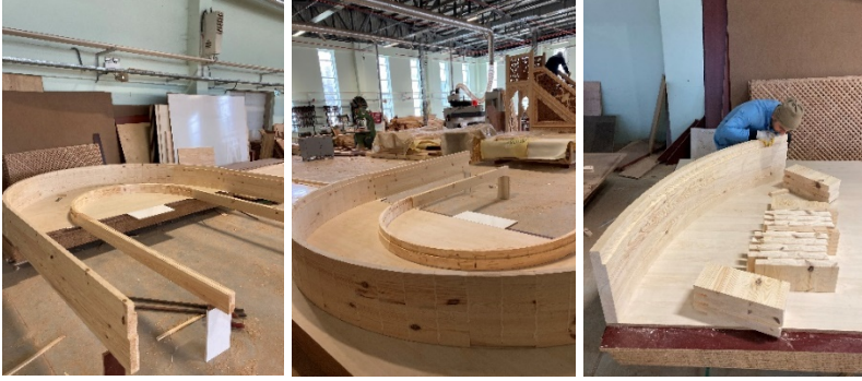
Şekil 12. Kemerli Taç Kapının açılı birleştirme işlemleri.
