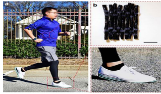
Şekil 12. Elektrik Üretimi Yapabilen Spor Ayakkabısı (Teng)
