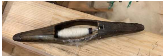
Fotoğraf 27: İçinde masura takılı bir mekik (Kiper, 2021).
