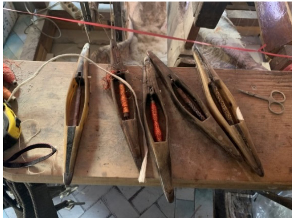
Fotoğraf 39: İç kuşak şerit desenlendirme ipliklerinin sarılı olduğu mekikler (Kiper, 2021).
