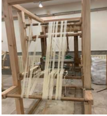
Fotoğraf 25: Alt ve üst mamerler (Kiper, 2021).
