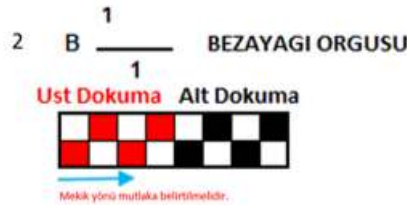
Fotoğraf 7: Bezayağı örgü raporu çizimi
