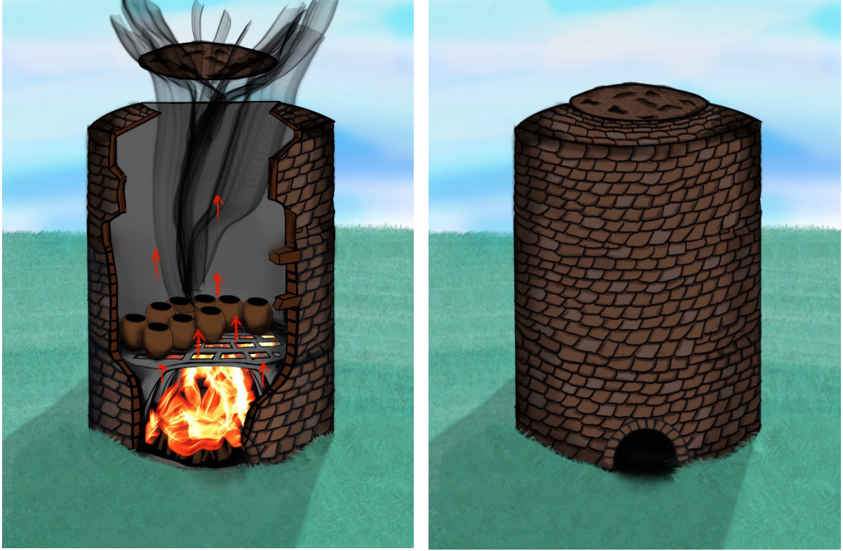
Şekil 6: Trabzon büyük çömlek fırını çalışma şeması.
