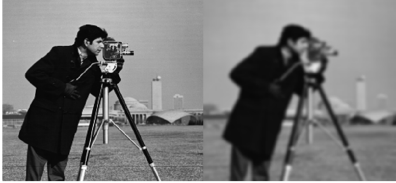
Şekil 7. Gauss filtresi uygulanan görüntü
