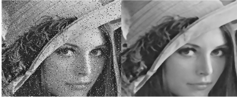
Şekil 6. Medyan filtresi ile temizlenen görüntü
