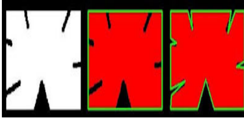
Şekil 8. Kontur bulma işlemi ile nesne tespiti
