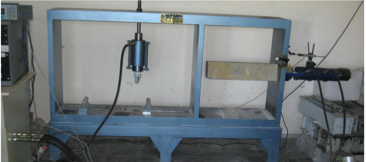
Şekil 2. Pull out deneyinin uygulaması
