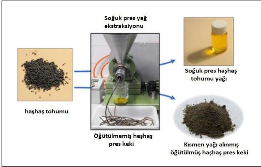
Şekil 2. Soğuk pres teknolojisi ile yağ ve pres keki eldesi (Melo vd., 2022)
