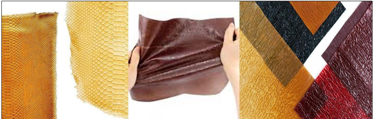
Şekil 9: “Tomtex” doğal hammadde ile üretilen ve deri görünümü verilen teknik tekstil (URL-18)
