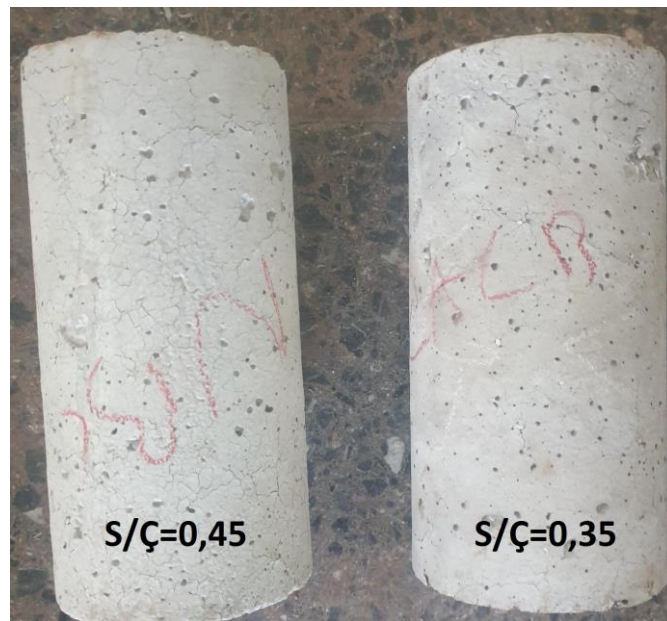
Şekil 6. Yüksek sıcaklık sonrası çatlak oluşumları
