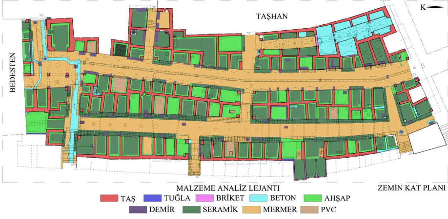
Çiz.4: Maraş Kapalı Çarşısı, malzeme analizi (EHA Yapı Mimarlık)
