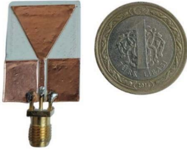
Şekil 5. 3D baskılı UGB antenin yama anten prototipi
