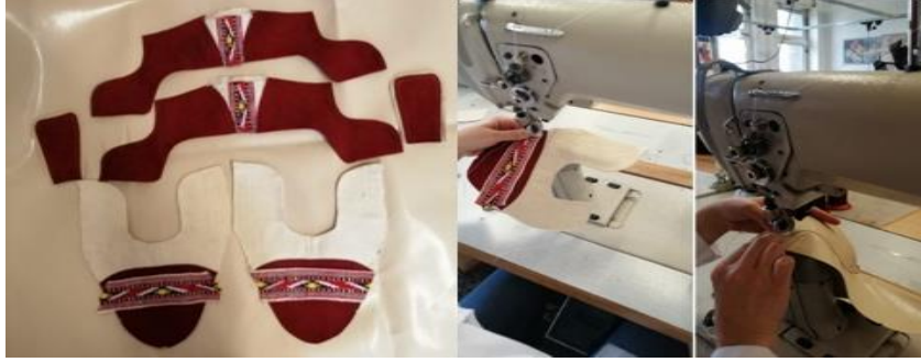
Şekil 6: Tezgah İşlemleri ve Saya Parçalarının Dikimi
