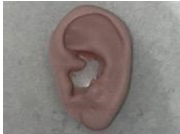
Resim 4. 3B yazıcıdan basılmış plastik kulak modeli
