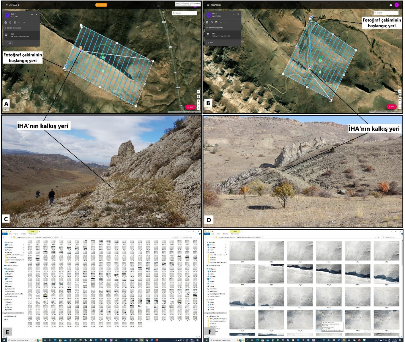
Şekil 7. DroneLink web sitesinden daha önce hazırlanan uçuş planlarında İHA'nın kalkış yeri (A ve B) ve arazide bu kalkış yerinin görünümü (C ve D). İHA ile çekilen koordinatlı ve bindirmeli fotoğraflar bilgisayar ortamında birbirini takip eden sıralı bir şekilde düzenlenmelidir (E ve F).
