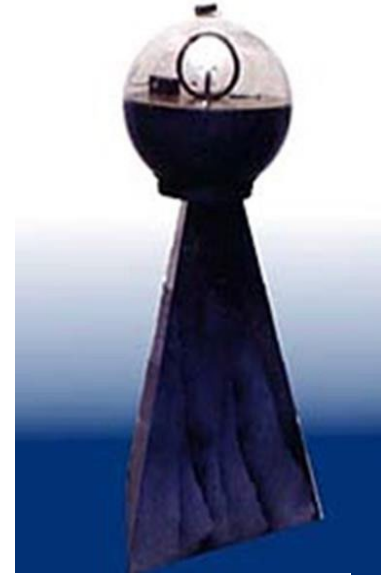
Resim 10: Yerin Manyetik Alanını Ölçen Deney Düzeneği
