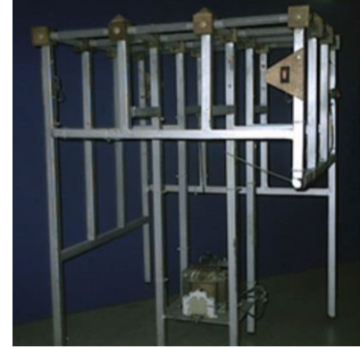
Resim 13: Seri-Paralel Yap Boz Deney Düzeneği.
