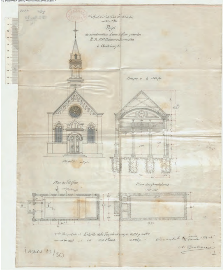
G. 13: Bulgar Katolik Okulu'nun avlusundaki kilise için 1894/1895 yıllarında Avadis Benliyan tarafından hazırlanmış olan proje (BOA, İ.AZN. 19/30, H-30-12-1313 [M 1896])
