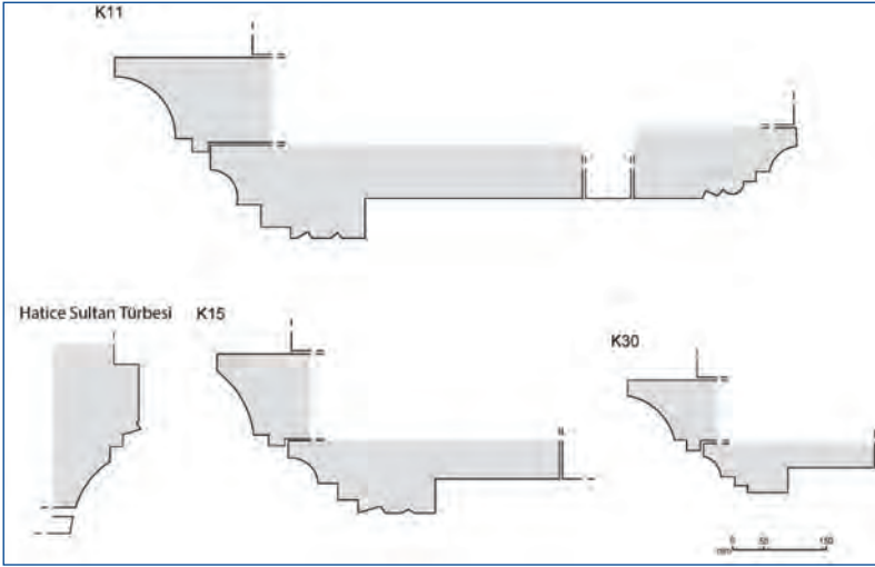
G. 9: Hüdavendigâr Camii ve Hatice Sultan Türbesi, kapı çerçeve profilleri (Ayşın Özügül, Egemen Deniz)
