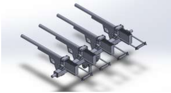
Şekil 1. Dört silahlı anti-İHA silah sistemi
