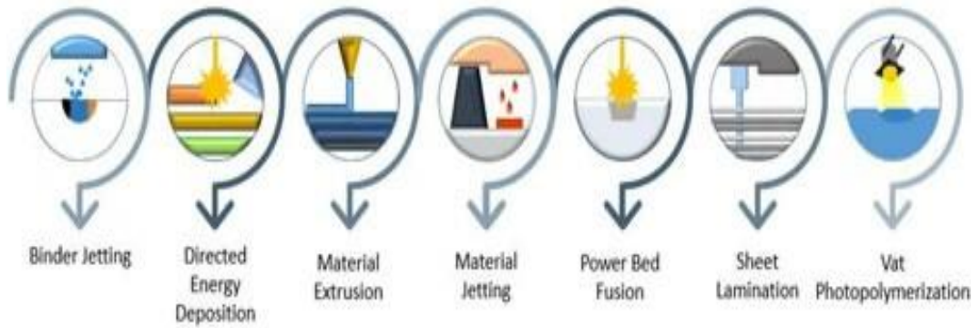
Şekil 2. ASTM Standardı F2792'ye göre 3B baskı tekniklerinin yedi ana kategorisi (Dip et al., 2021)
