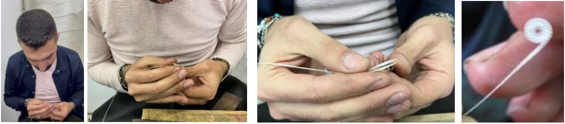
Görsel 37-40. İç dolgu için mekik ve tekerlek modellerinin hazırlanması (Aday Gürkan Telkâri Atölyesi)
