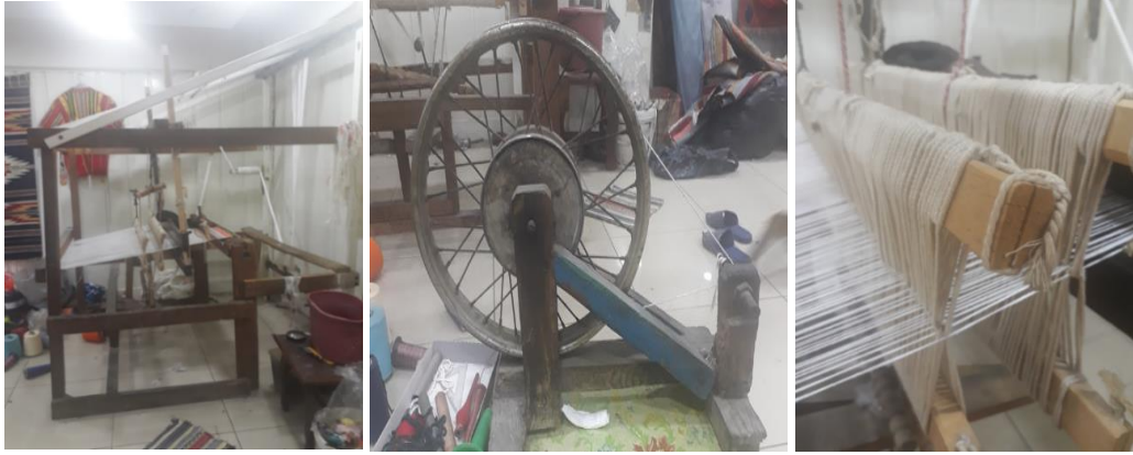
Fotoğraf 2, 3, 4. Hatay aba dokuma tezgâhı ve yün eğirme çıkırığı, Abdulla Akar'ın atölyesinden (Ariöz, 2020)
