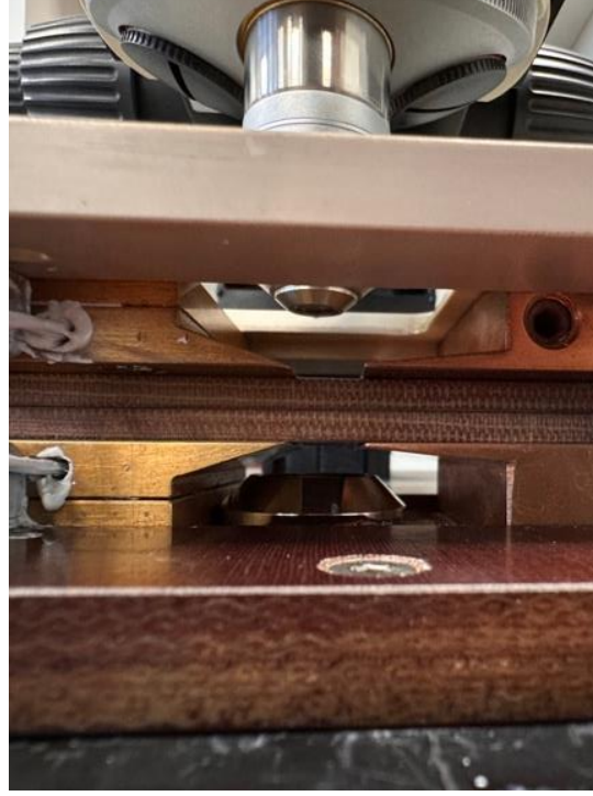
Şekil 8. Dik (üst) ve çevrik (alt) mikroskoplardan numunedeki aynı bölgeyi görüntülediği gösteren fotoğraf.
