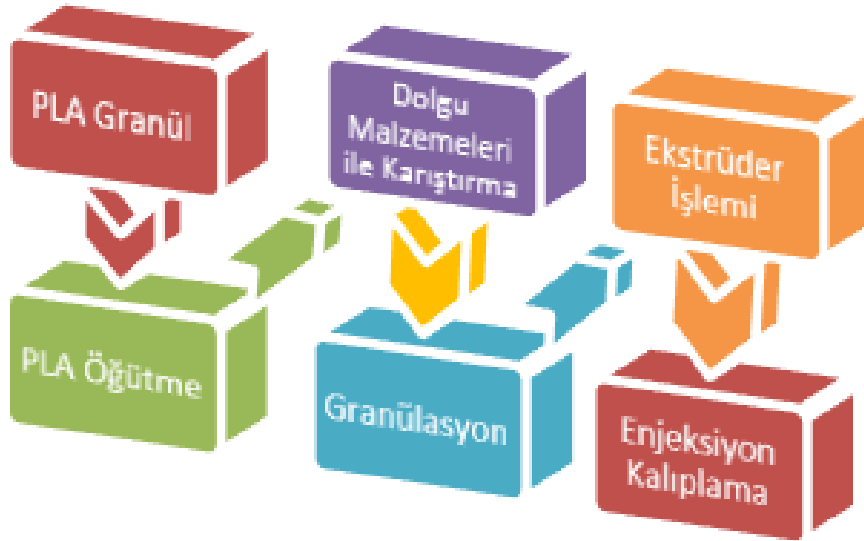
Şekil 2. Biyokompozit üretim aşamaları
