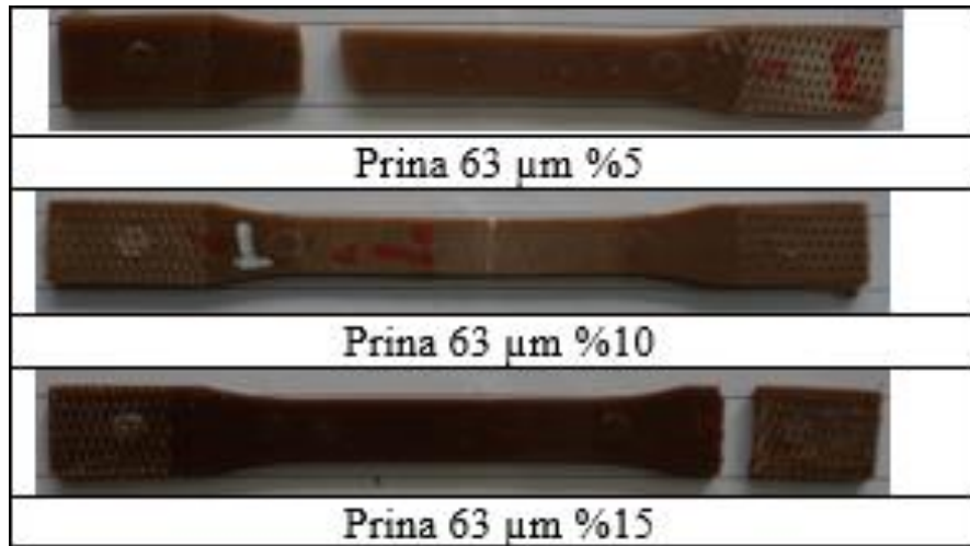
Şekil 5. Çekme sonrası numune örnekleri
