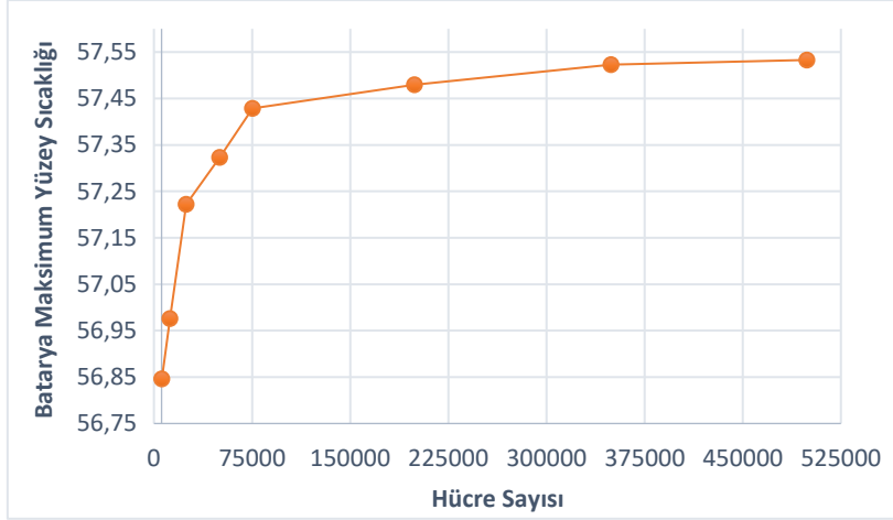
Şekil 7. Farklı hücre sayılarına göre batarya maksimum sıcaklık değerleri değişimi
