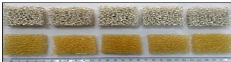
Şekil 11. Kullanılan polimerik sünger ve çamurun emdirilmesini takiben kurutulmuş gözenekli seramik numunelerin makro görüntüleri (Özey, 2018).
