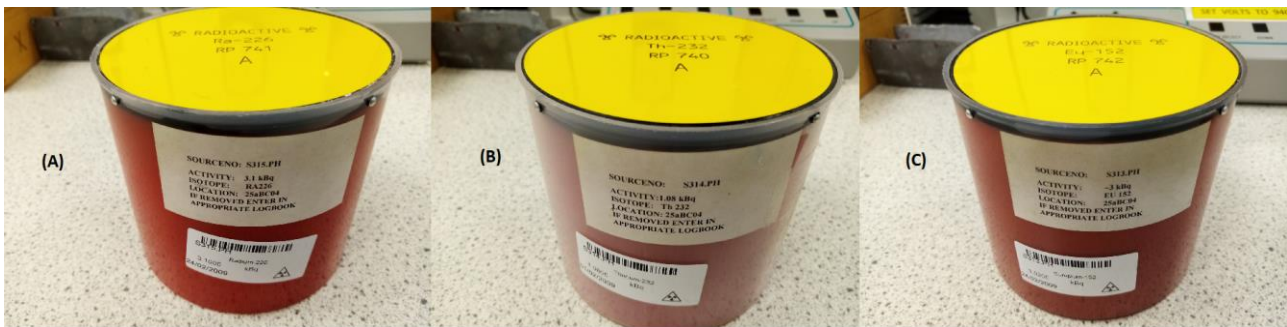
Şekil 1. HPGe dedektörünün kalibrasyonu için kullanılan radyoaktif standart kaynakları ((A) Ra-226, (B) Th-232 ve (C) Eu-152 radyoaktif standart kaynakları)
