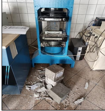
Şekil 5. Basınç dayanımı deneyi (Compressive strength test)
