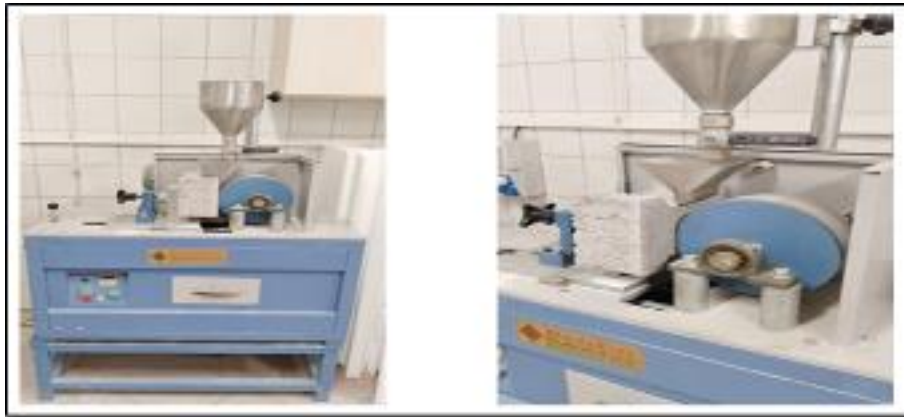
Şekil 4. Aşınma direnci deneyi (Wear resistance test)
