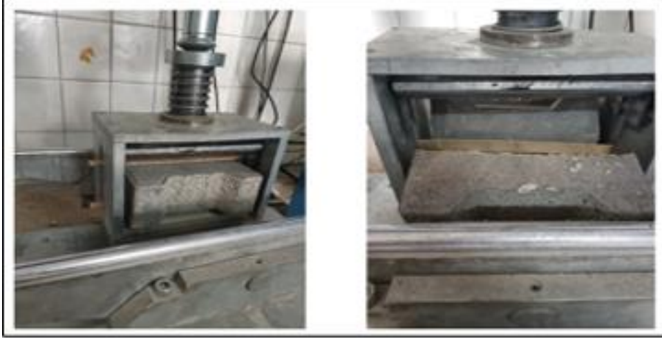
Şekil 3. Yarmada çekme dayanımı deneyi (Splitting tensile strength test)
