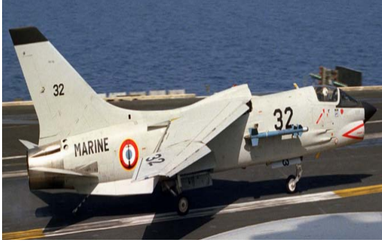
Şekil 1. Değişken hücum açılı kanada sahip F-8 jeti
