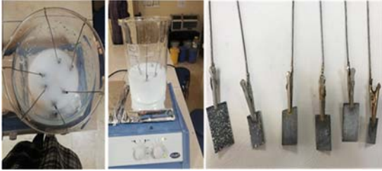
Şekil 1. Erozyon korozyonu deney düzeneği ve deney sonu numuneler
