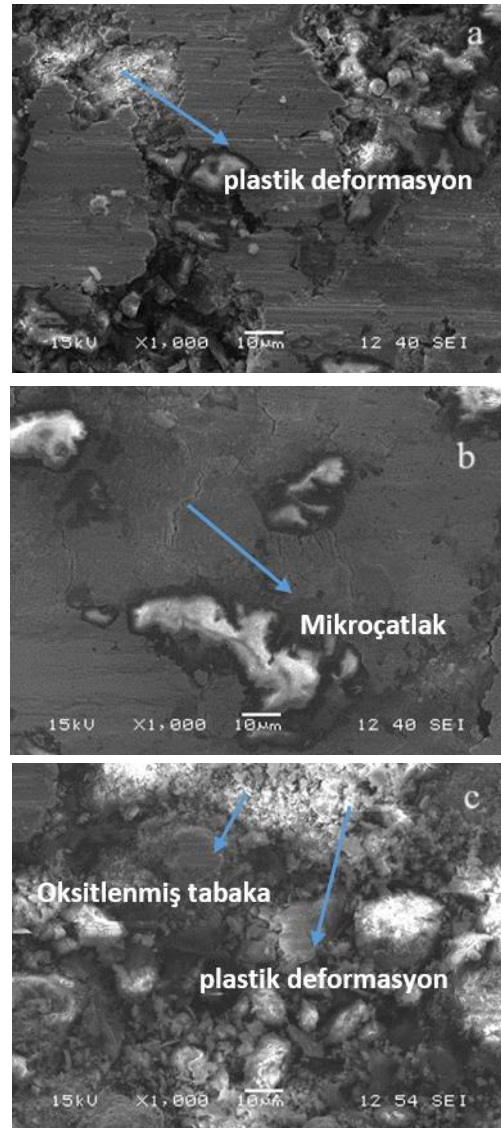
Şekil 11. Farklı oranlarda takviye edilen B 2 O 3 ilaveli bronz esaslı kompozit malzemelerin aşınmış yüzeylerinden alınan SEM görüntüleri (a) %2 B 2 O 3 (b) %4 B 2 O 3 (c) %6 B 2 O 3 takviyeli
