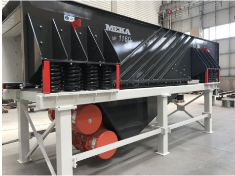
Figure 1. Vibrating feeder and wobbler feeder Şekil 1. Titreşimli besleyici ve wobbler besleyici
