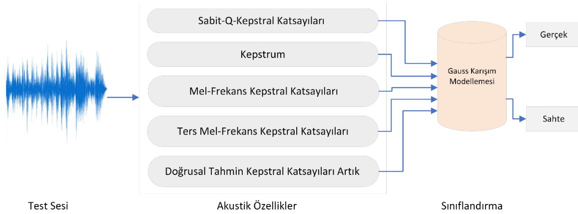
Şekil 10. Beş farklı akustik özelliklerin Gauss Karışım Modellemesi ile sınıflandırılmasına dayalı derin sahte ses tespiti yöntemi (Witkowski ve ark., 2017).
