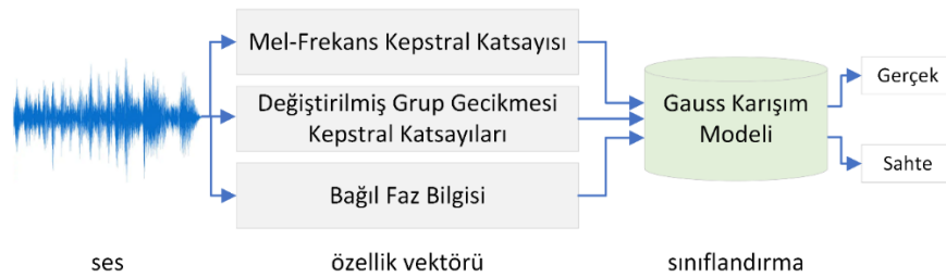
Şekil 5. Üç farklı akustik özelliğın Gauss Karışım Modeli ile sınıflandırılmasına dayalı derin sahte ses tespiti yöntemi ( Wang ve ark., 2015 ).
