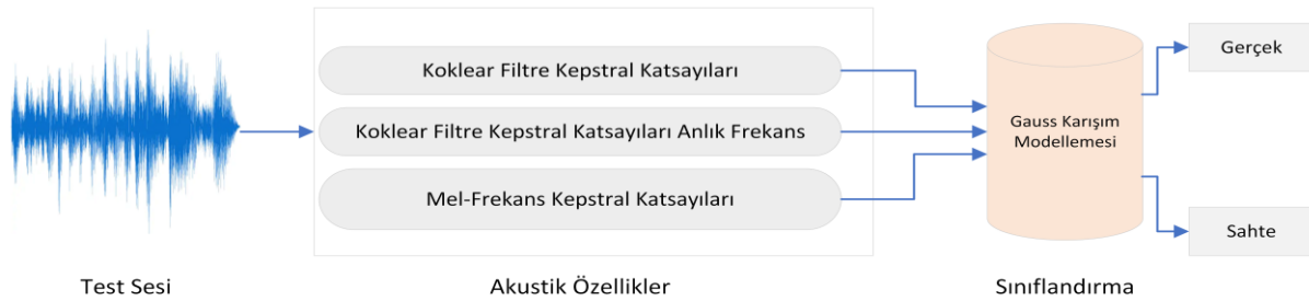
Şekil 7. Üç farklı akustik özelliğin Gauss Karışım Modellemesi ile sınıflandırılması ile derin sahte ses tespiti yöntemi (Patel & Patil, 2015).
