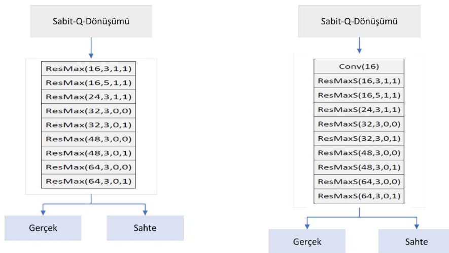
Şekil 28. ResMax ile derin sahte ses tespiti yönteminde kullanılan mimariler (Kwak ve ark., 2023).
