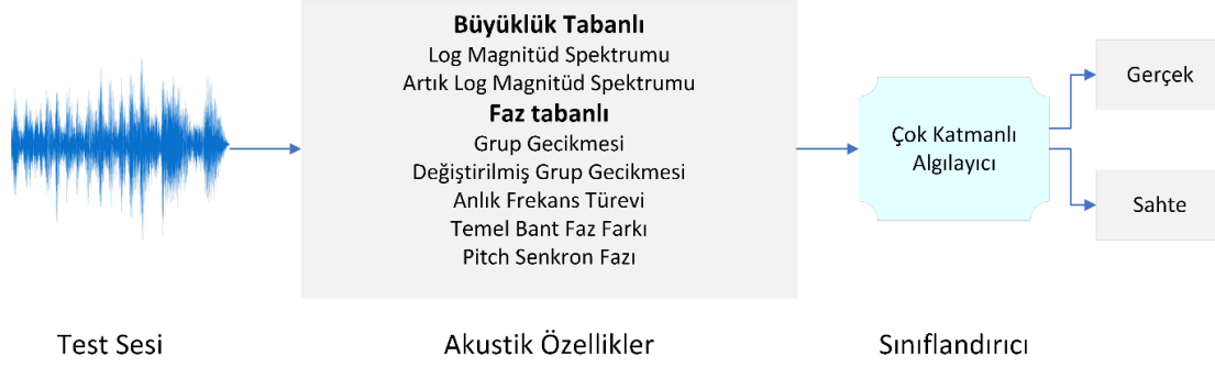
Şekil 6. Yedi farklı akustik özelliğin çok katmanlı algılayıcı ile sınıflandırılması ile derin sahte ses tespiti yöntemi (Xiao ve ark., 2015).
