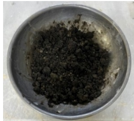
Şekil 2. Kurutulmuş yosun katkılı ıslak zeolit-bentonit karışımı.
