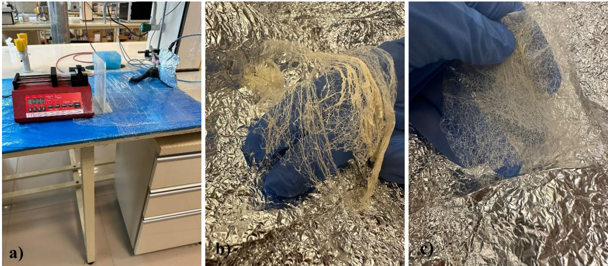
Şekil 2. (a) Elektrosinning düzeneği ile elde edilen (b) PJ ve (c) PJ-ÇE liflerinin görüntüsü.
