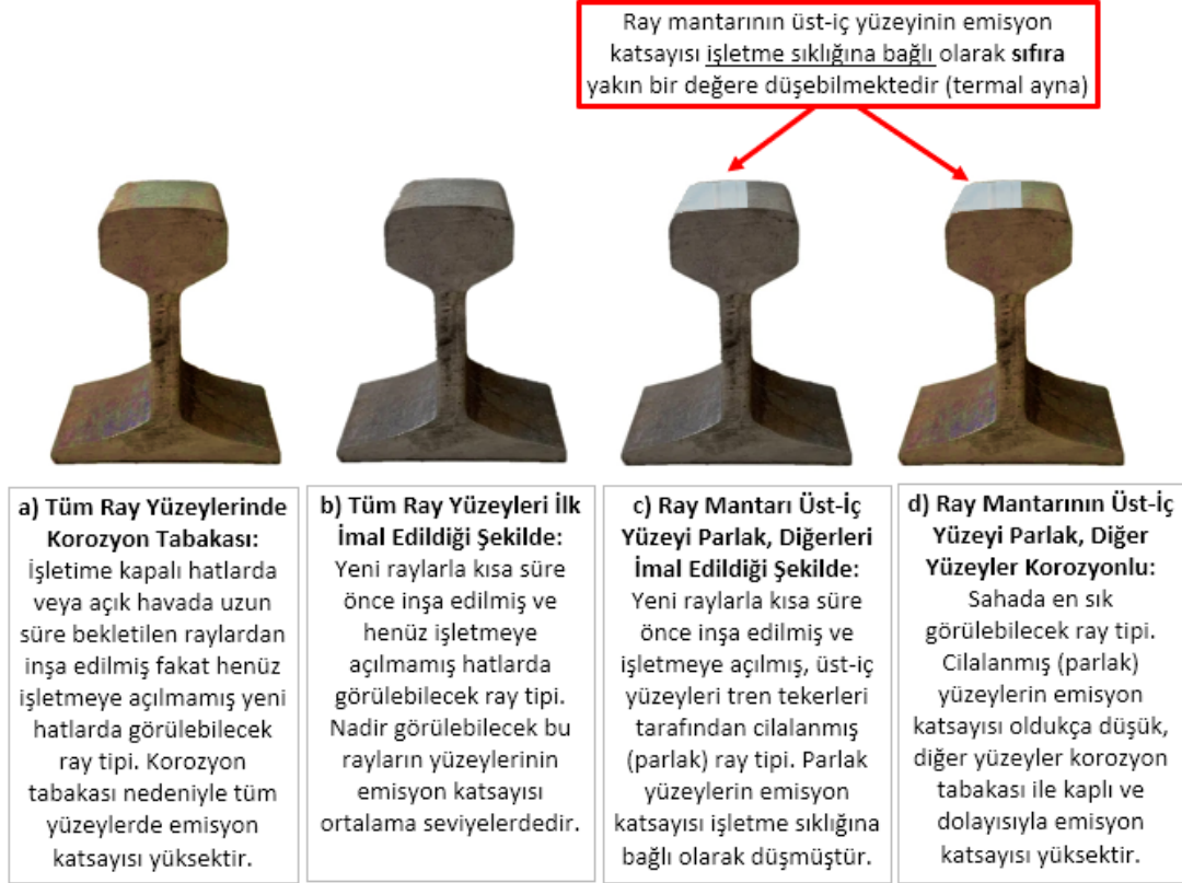
Şekil 7. Ray emisyon katsayılarının işletim sıklığına ve korozyon düzeyine bağlı olarak değişkenliği
