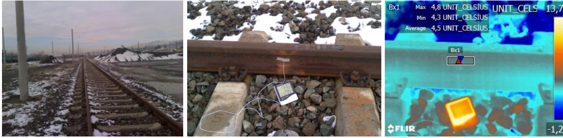
Şekil 11. Önerilen ölçüm ve analiz prosedürünün ilave kontrolü için alınan termal görüntüler (Ocak 2024)
