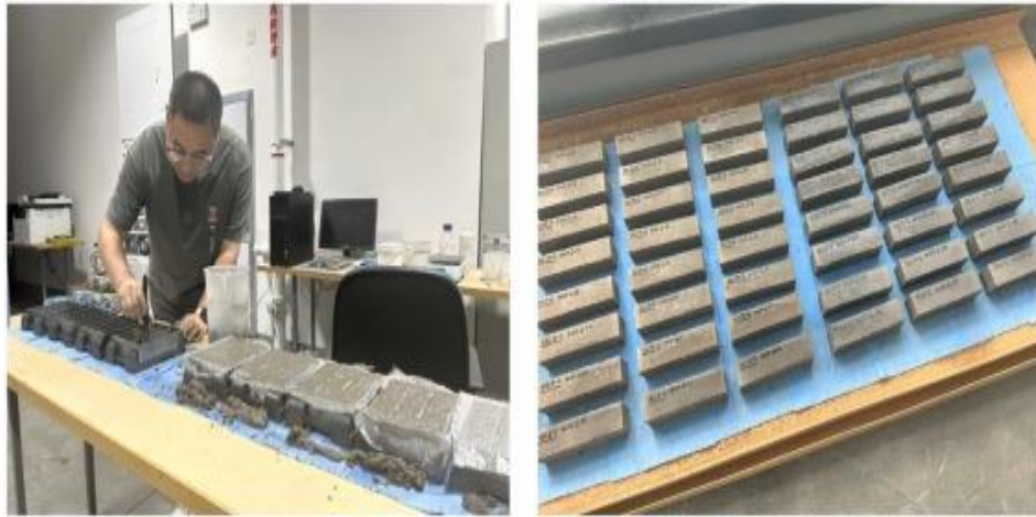
Şekil 3: FDM katkıli tuğlaların üretimi aşaması (Li vd., 2024).
