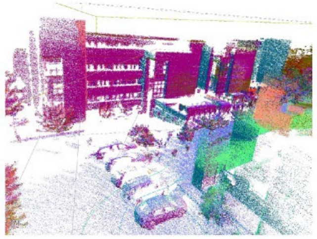
Şekil 4. Çalışma alanının 3B nokta bulutu.
