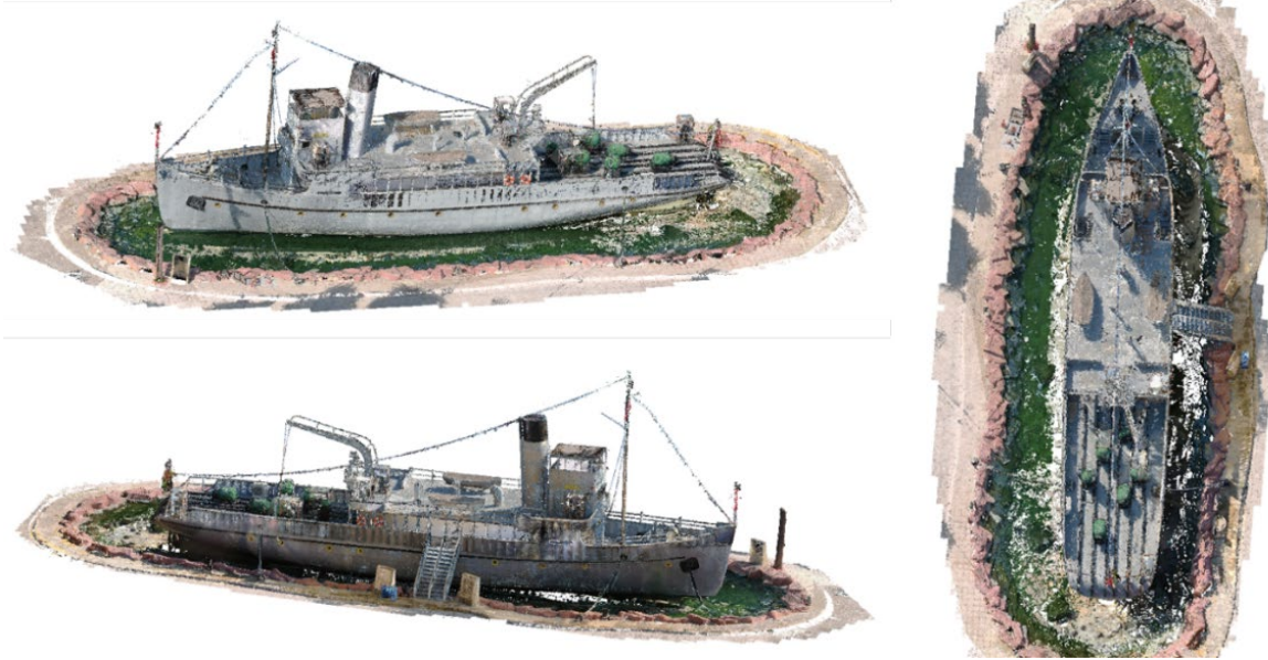
Şekil 13. YLT ve İHA ile elde edilen nihai yoğun nokta bulutlarının birleşmiş hali.
