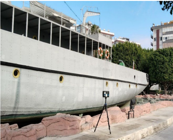
Şekil 6. YLT ile veri toplama (İskele tarafı).
